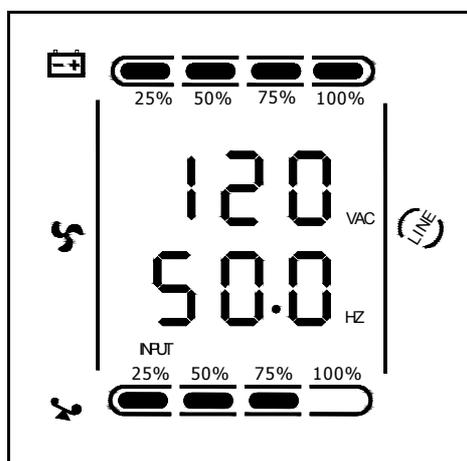
**Battery** : バッテリーの電圧と容量を表示します。(例)バッテリー電圧 : 24V、バッテリーの容量 : 100%
