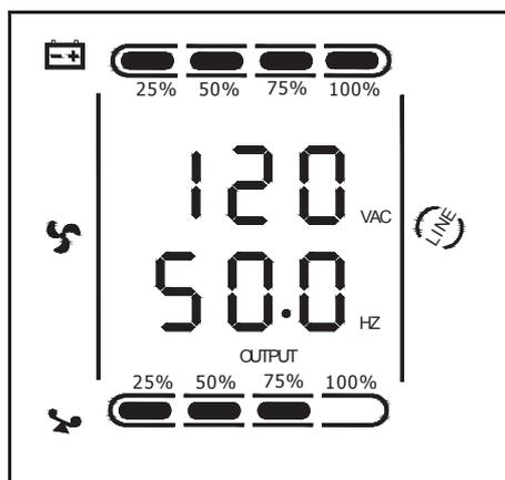
**Load** : 有効電力（ワット）と負荷の皮相電力（VA）の数値を表示します。
