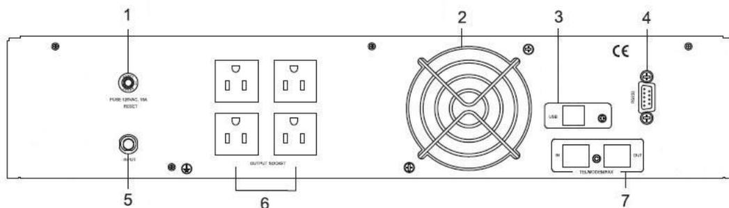
1.サーキットブレーカー、2.冷却ファン、3.USB 端子、4.RS232 端子、5.入力電源ソケット、6.出力電源ソケット、7.TEL/FAX サージ保護端子
